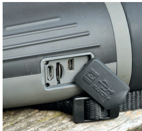
Konektory pro rozhraní HDMI a USB a slot pro paměťovou kartu jsou pod gumovou krytkou na pravé straně těla.
