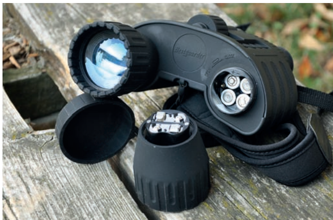
Výšroubováním reflektoru přísvitů se otevře přístup k pouzdru na baterie.
